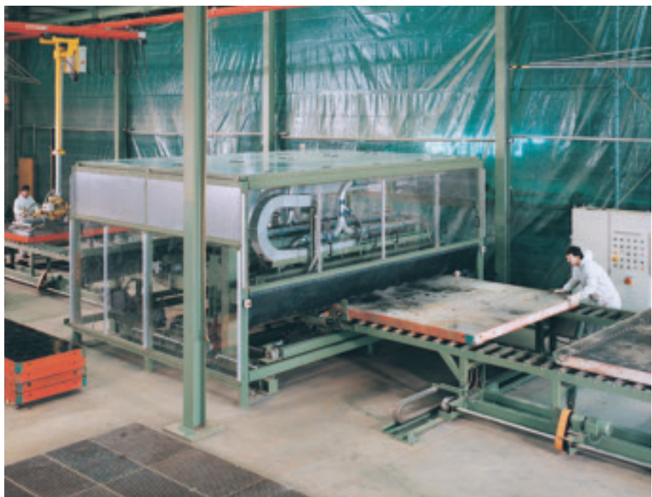
Очистительная установка компании PERI в действии.
