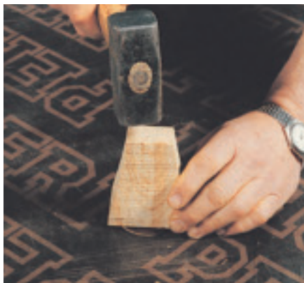
Нанести клей и вбить фанерную пластинку.
