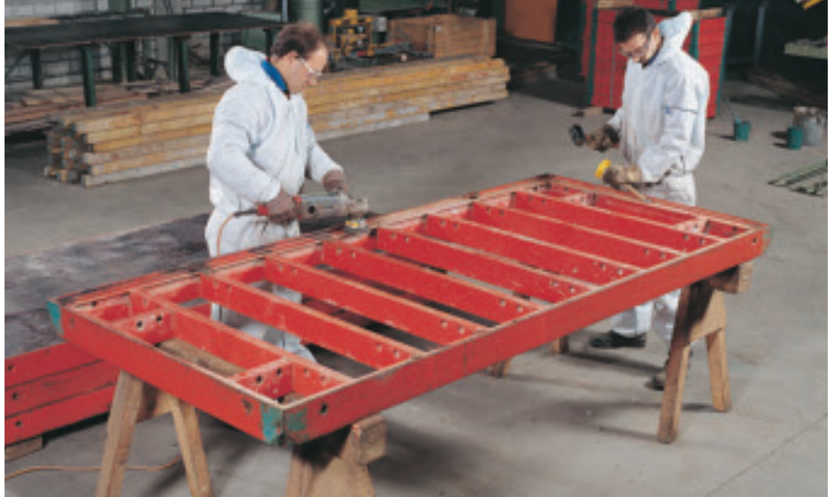
Удаление заклепок и очистка рамы.
